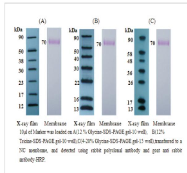
普通Marker只使用到转膜步骤，曝光Marker能够在X胶片上曝光显色。因此，曝光Marker作为对照，能够提示解决Western blot试验中的一切问题。
